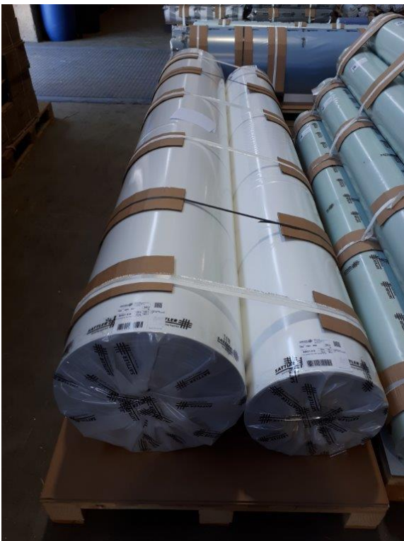
Die Membran, abgepackt und transportfertig. Auf der großen Rolle sind ca. 140 m und auf der kleineren 60 m, jeweils ca. 3 m breit. Eine Rolle wiegt ca. 800 kg.
